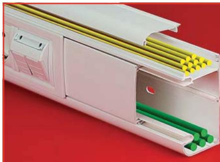
В коробе 90/2x50 мм (код 09500) встроенный разделитель создает 2 независимых отсека с крышками для удобной прокладки различной проводки. Разделитель имеет преперфорацию для перевода кабеля из одной секции короба в другую при необходимости.
