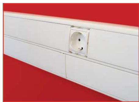
Установите крышки короба и сдвиньте их к каркасу с ЭУИ, оставив зазоры по 3 мм
