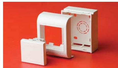
Второй тип коробок - это универсальные монтажные коробки PDD-N60 (на 2 модуля) и PDD-N120 (на 4 модуля). Коробки PDD-N60 поставляются как отдельно, так и укомплектованные электроустановочными изделиями серии "Brava". В коробки PDD-N60 можно монтировать ЭУИ с посадочным размером 60 мм производства ДКС (серии "Viva" и "Brava") и других производителей. В коробки PDD-N120 монтируются ЭУИ с посадочным размером 108 мм "Viva", "Brava" или других производителей.
