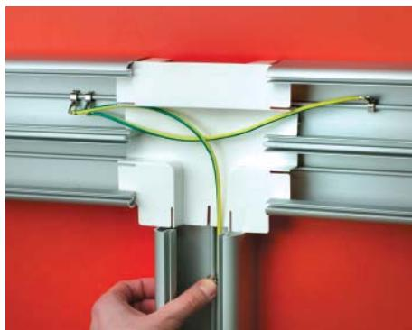
Проводом заземления код E0001B соедините основание одного из двух коробов с основанием третьего короба. Клеммы защелкиванием установите на направляющие на дне этих коробов.
