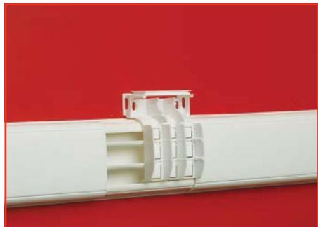
Установите базу отвода на кабель-канал и закрепите на стене. Для отведения проводки удалите ненужные участки преперфорации
