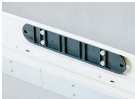
Для определения точек крепления соединителя GTA-SN используйте разметку на самом разделителе. По карандашным отметкам на коробе дрелью просверлите отверстия, используя сверло диаметром 6,5 мм
