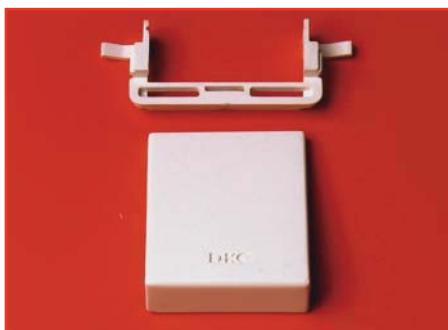
1. Для монтажа коробки над миниканалами 40x17 и 50x20 используйте дополнительный адаптер 10046. (с миниканалом 40x17 – обрежьте часть верхней боковины миниканала шириной 46 мм и установите базу адаптера в прорезь, лапками вниз
