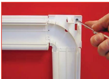
Вставьте в базу угла вторую часть кабель-канала. Закрепите их на стене
