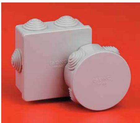
**Назначение:** коробка ответвительная предназначена для декоративного оформления и защиты от механических повреждений, пыли и влаги мест соединения кабелей силовых и осветительных электрических сетей напряжением до 1000 В переменного и постоянного тока, а также кабелей информационных сетей (телефонных, компьютерных, телевизионных, сетей связи и пр.). Предназначены для открытой установки как в помещениях, так и на открытом воздухе под навесом.
