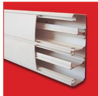
В короб 140x50 мм можно установить 2 крышки шириной 60 мм, несущий разделитель и разделители SEP-N60/50 и SEP-N40. Получается электроустановочный короб с 4-мя отсеками (секциями)
