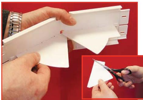
Вставьте разделители в направляющие на базе угла. Для углов менее 90° рекомендуется отрезать часть разделителя
