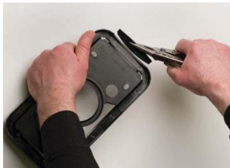
В случае если кабели подводятся к башенке в напольном канале – вырежьте отверстие под канал в основании башенки (преперфорация имеется с 4-х сторон)
