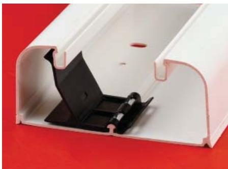
Держатель кабеля устанавливаются защелкиванием на направляющую, расположенную на дне короба. Держатель кабелей предназначен для удобства организации внутреннего пространства короба, а также удерживает кабели внутри короба, что особенно важно при монтаже вертикально расположенной трассы.
