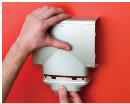
При отводе от трассы коробов 140x50 мм короба 90x50 мм вставьте в декоративную накладку тройника переходник 140-90x50 код 01408G. При отводе короба 110x50 вставьте переходник 140-110x50 код 01010G.
